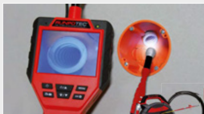
Inspection de conduites diamètre tubes > Ø 14 mm
