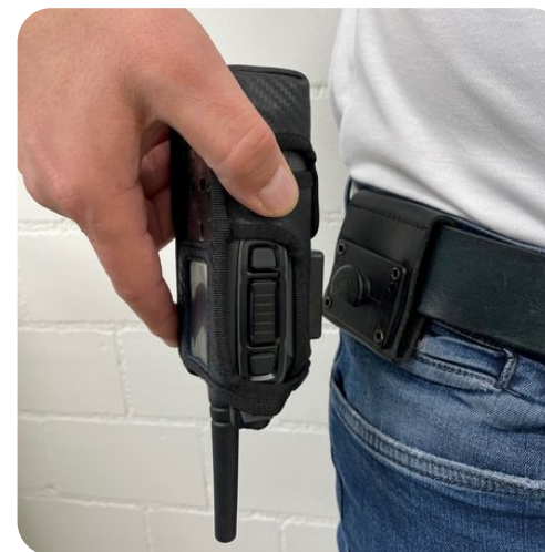
Rimozione attraverso la posizione "a testa in giù"
