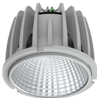
Unser universelles LED Modul kann man mit 5 verschiedenen Einbauringen kombinieren. Zudem können mittels DIP-Switch zehn Leistungsabstufungen eingestellt werden. Der im Lieferumfang enthaltene LED Treiber bietet folgende Möglichkeiten (On/Off, DALI, 1-10V, Push-Dim)
